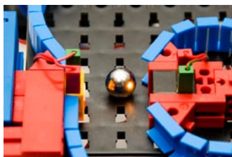
Célula fotoelétrica para a medida de passagem
