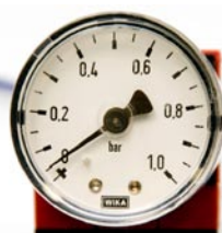
Manomètre pour la mesure de la pression de l'air
